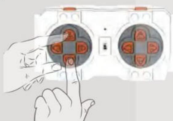
Pro změnu směru stiskněte a podržte tato dvě tlačítka současně po dobu přibližně 3 sek., blikající kontrolka signalizuje úspěšné obrácení směru otáčení, totéž platí pro ostatní tlačítka
