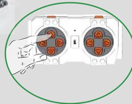
在此处打开模块1，打开遥控器连接，按遥控器上下A键（A通道），控制座椅伸缩。
